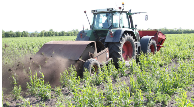
Billede 5. Forsøg med mekanisk og kemisk ukrudtsbekæmpelse i pil ved Ikast, 2011. Rækkefræsningen der blev anvendt til forsøget, dog fotograferet på en anden mark. (Foto: Søren Ugilt Larsen, AgroTech).
